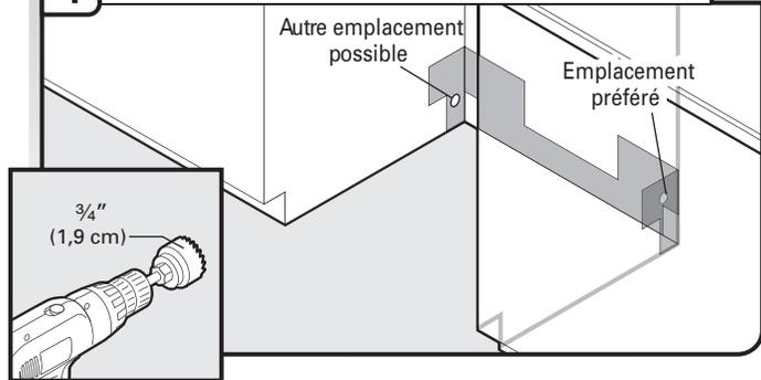
Percer un trou de  $\frac{3}{4}$ " (1,9 cm) dans le panneau latéral du placard de droite ou à l'arrière.
